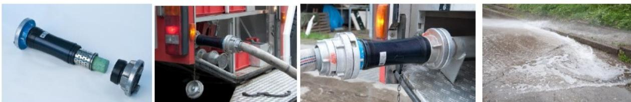
Hasí se běžnou technikou s ohledem na situaci na požářišti. Při hasebním zásahu je vhodné skrápět i okolní plochy, které jsou díky ošetření hasivem efektivně smočeny a lépe odolávají vzplanutí a poškození sálavým teplem. V případě nutnosti použít během zásahu pěnidlo není nutné kartuši odstraňovat, pěnidlo je možno přimísit do používaného proudu. Tuhé smáčedlo funkčnost a účinnost pěnidla neovlivňuje.
